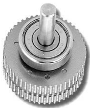
Figura 6: Sobre el eje del motor está fijado un cilindro provisto de 2 rangos de dientes magnéticos que se posicionan frente a las bobinas
